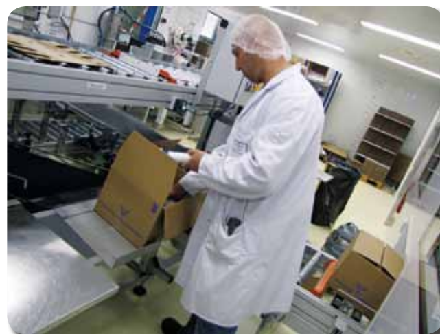
Eric Floriani, chef de projet, présente la nouvelle installation pendant les essais : plan de travail réglable, alimentation des intercalaires, bouton d'appel, visualisation des informations sur l'activité de la ligne, desserte pour stock tampon
