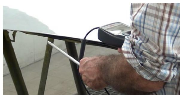
Critère n°2 : Mesure des vitesses d'air à l'aide d'un anémomètre à l'intérieur d'une cabine aspirante à flux vertical
