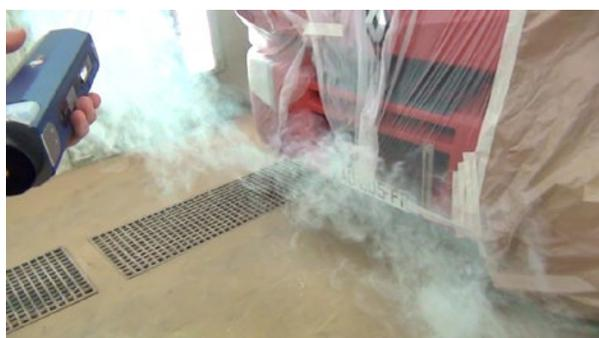
Critère n°1 : Captage intégral de la fumée émise au niveau d'une cabine ventilée à flux vertical lors de la peinture d'un camion
