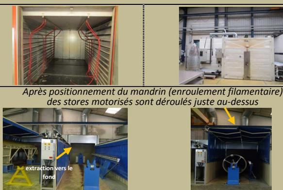
Après positionnement du mandrin (enroulement filamenteire) des stores motorisés sont déroulés juste au-dessus
