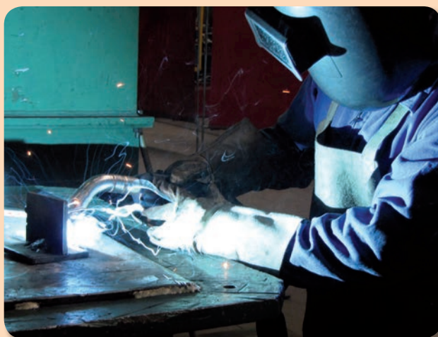
"Avec la torche aspirante, on voit mieux le cordon de soudure"
