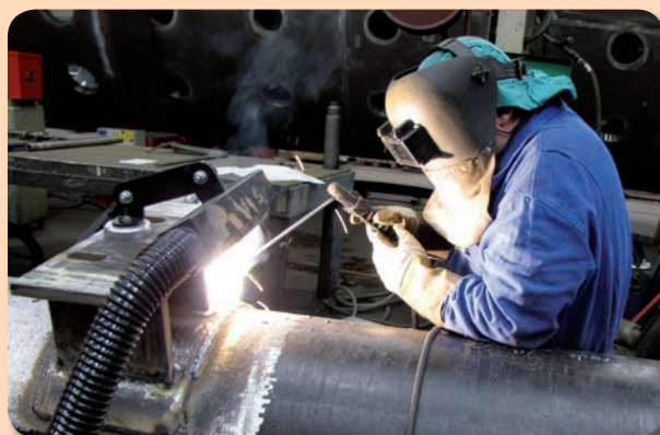
Un des capteurs laminaires utilisé pour le soudage à la baguette
