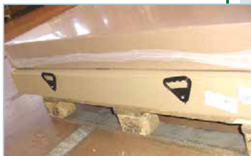
Poignées fixées à l'emballage pour les articles encombrants et pondéreux
