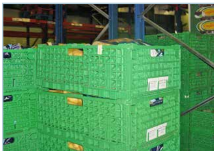
Caisnes plastiques repliables avec 4 poignées
