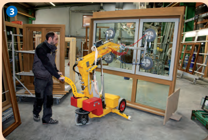
Le robot de manutention utilisé généralement sur les chantiers.
