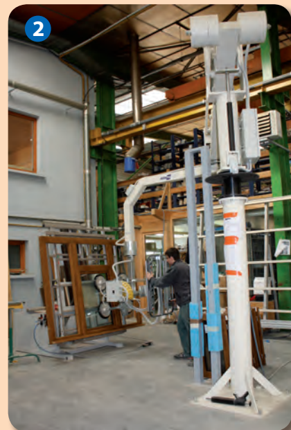
L'industrialisation de l'atelier a permis l'installation d'outils de préhension performants. Ci-dessus, une potence de manutention : un seul opérateur positionne sans effort et sans risque un élément pesant plusieurs dizaines de kilos. Il fallait de 2 à 4 personnes auparavant.
