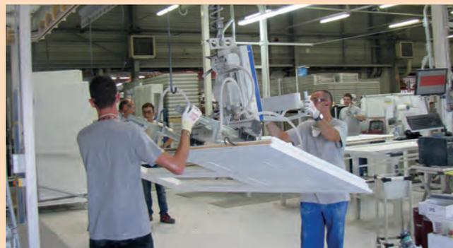
Le bras manipulateur du poste carrosserie utilisé « quelquefois » pour mettre en place les panneaux sur la chaîne de laquage.
