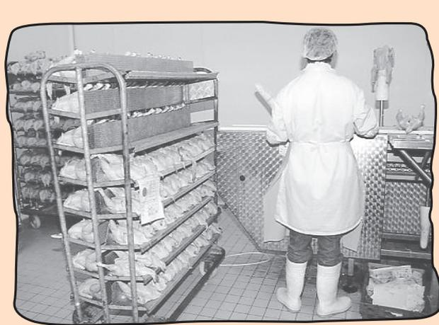
La mise des volailles sur obus consiste à alimenter une chaîne de découpe de volailles. L'opérateur positionne en début de chaîne un chariot sur lequel les volailles sont stockées, puis il les empale sur des obus qui défilent devant lui. Les volailles passent devant les différents postes de découpe (cuisses, ailes...).
