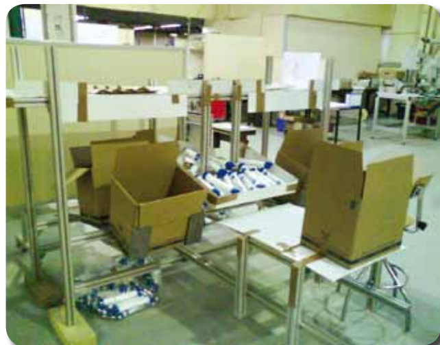
Du carton, des plaques de polystyrène, du scotch : la maquette testée chez le fabricant du poste par les 15 futurs occupants des postes de conditionnement.
