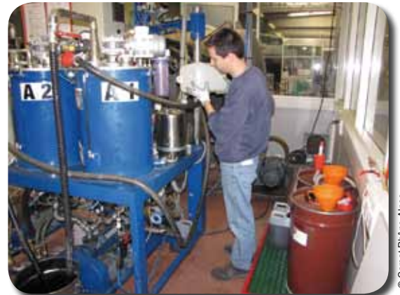
Alimentation de la machine de coulée des transformateurs "... Plus besoin de porter des masques pour travailler"
