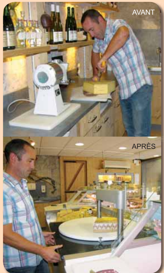
Indication du trait de coupe par un rayon laser, commande de la coupe par une commande bimanuelle
