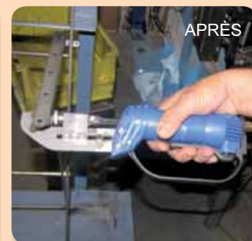
Assemblage des chaises avant, à la pince... maintenant au sécateur pneumatique
