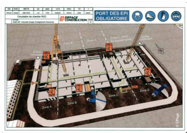
Plan : Les accès et les zones de circulation bénéficient d'un affichage sur le chantier. Ci-dessus : un exemple d'affiche.
