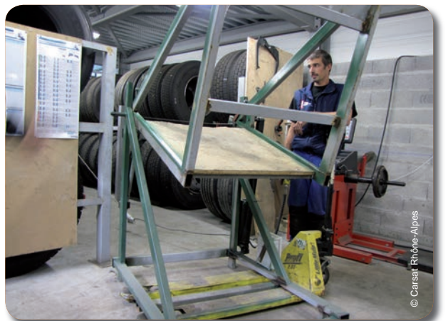
Basculéur destiné à la manutention des roues de PL manipulé par Alexis Collin, son concepteur.
