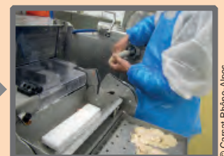
3. Embossage (mise sous boyau à la sortie des mélangeurs)
