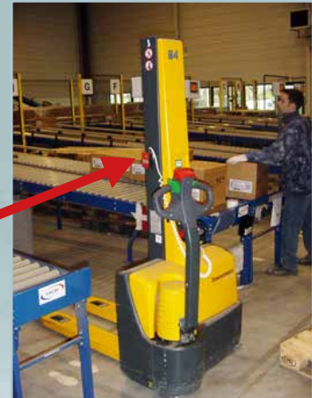
Transpalette gerbeur avec mise à hauteur automatique des fourches
